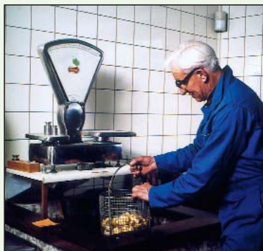
Determinação do peso em água de uma amostra de batatas
